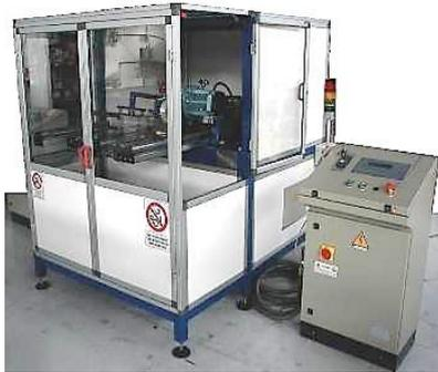
La **Foratrice** è una macchina che consente la foratura di nastri e/o cinghie sia chiusi ad anello, che aperti. Una ruota di traino fa scorrere il nastro al di sotto di un punzone, il quale a sua volta ha un movimento in direzione perpendicolare alla direzione di avanzamento del nastro che gli viene fornito da una guida lineare. La composizione dei due moti permette una elevata flessibilità del "disegno di foratura".
